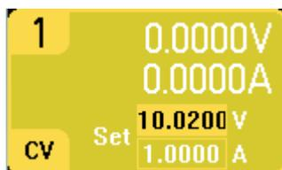
3. 按 **Settings** 键可以访问 Source Settings 窗口。使用导航键突出显示 **Voltage** 或 **Current** 字段。然后使用数字键输入电压和电流值。按 **Enter** 键输入该值。
